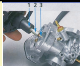
Пусковое устройство: 1 - корпус, в котором расположены нагреватель и термостат; 2 - запорный цилиндр; 3 - дозирующая игла
